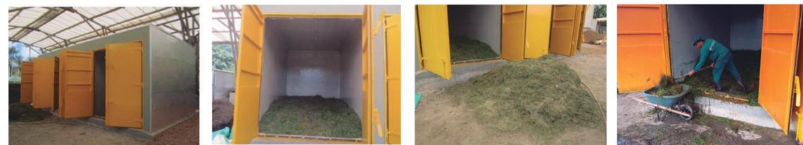
La mezcla de entrada no debe ser demasiado húmedo o demasiado seco. El contenido de materia seca debe ser de entre 25 y 50%, con un óptimo de aproximadamente 30%. El lixiviado recircula para mantener homogeneidad en la humedad y re-inocular permanentemente.
